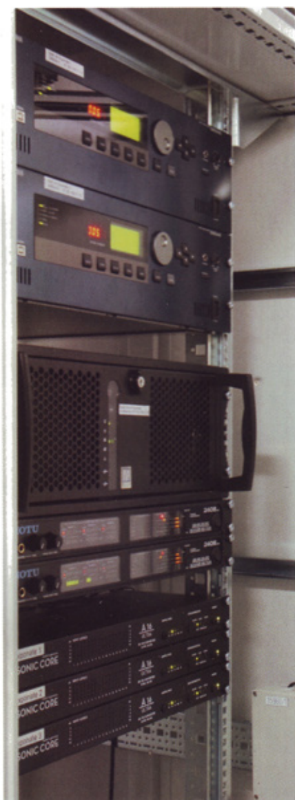
Für die Aufbereitung der Audiosignale werden DME64-Prozessoren von Yamaha herangezogen; als Audiointerfaces stehen „2408mk3“-Einheiten von MotU sowie als D/A-Umsetzer genutzte Interfaces („A16 Ultra“) der Siegburger Sonic Core GmbH bereit. Als Klanglieferanten fungieren Audioserver von inSynergie.
